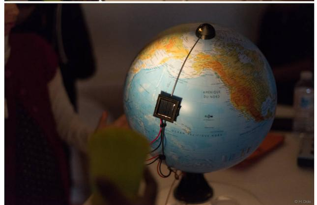
Expériences sur chaque table de l'efficacité des cellules photovoltaïques en fonction de l'angle d'incidence.
